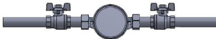
Rys. 2 – Pozioma pozycja montażowa z liczydłem skierowanym w bok.
