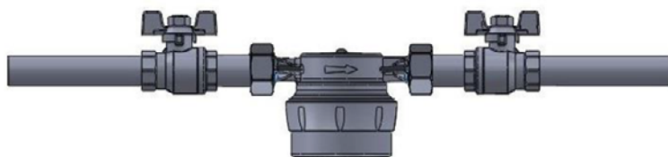
Rys. 3 – Pozioma pozycja montażowa z liczydłem skierowanym w dół.
