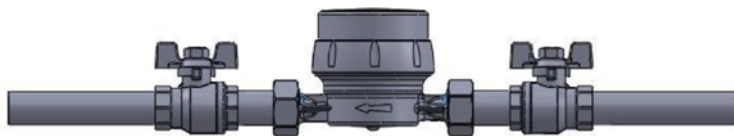
Rys. 1 – Pozioma pozycja montażowa z liczydłem skierowanym do góry.
